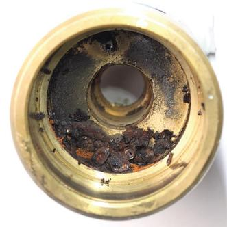
Abbildung 1: Ansammlung von mächtigen Eisenkorrosionsprodukten im Gehäuse einer Dreheinführung der Farbreiberkühlung an einem Druckwerk.
