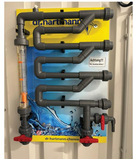
Abbildung 2: Korrosionsmessstrecke im geschlossenen Kühlkreislauf zur Bestimmung der Korrosionsraten für vier Coupons.
