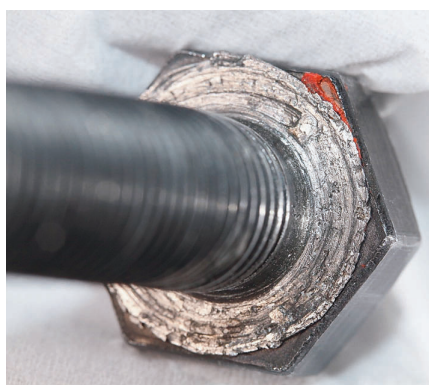
Abbildung 3: Herausgedrehte Schraube mit ausgeprägten, adhäsiven Fressspuren an der Kopfauflage.
