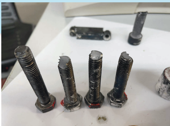
Abbildung 2: Zwei abgescherte Schrauben einer Greiferbrücke (antriebsseitig) und eine abgescherte Schraube (bediensseitig) sowie eine herausgedrehte Schraube (bediensseitig).
