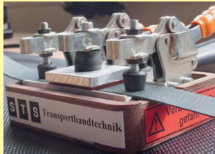
Heizklebepresse für die Verbindung von ausgeschärften Bändern. Dabei ist genau auf die korrekte Laufrichtung der Bänder zu achten. Beschädigungen der Verbindungsstelle durch Bandrollen sind zu vermeiden.
